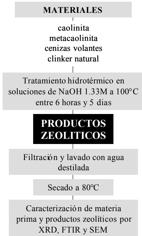
Figura 1. Diagrama de flujo ilustrando el método hidrotérmico para la síntesis de zeolitas.
