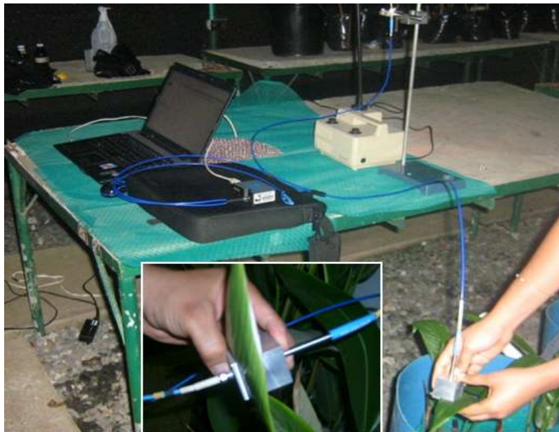
Figura 3. La fotografía muestra el montaje utilizado para la adquisición de espectros de Reflectancia y Transmitancia. El detalle, en la parte inferior, presenta el adaptador diseñado para fijar la hoja y acoplar las fibras ópticas.
