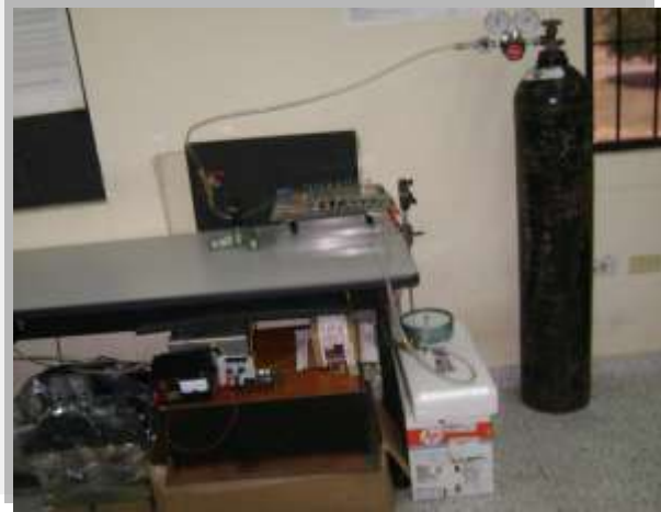
Figura 7: Sistema de medición de la radiación emitida por el prototipo Láser de Nitrógeno y Montaje experimental.
