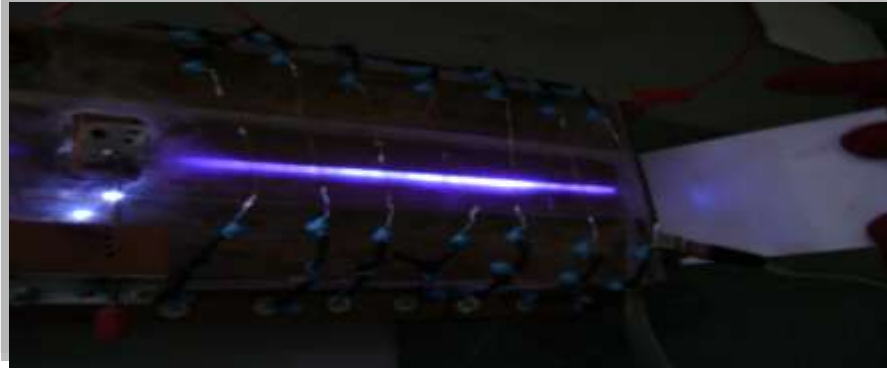
Figura 5: Súper fluorescencia emitida por el prototipo Láser de Nitrógeno.
