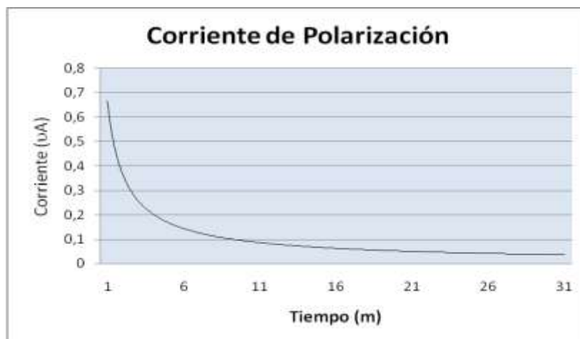
Figura 3. Curva típica de la corriente que atraviesa la muestra durante un proceso exitoso de polarización electotérmica.
