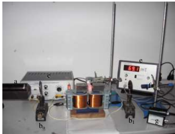
Figura. 2 Montaje experimental: a: Laser de Helio-Neón, b 0 y b 1 : polarizadores, c: fuente de 20VDC, 12A, d: electroimán, e: teslámetro digital, f: Sensor de intensidad, g: Interfaz Go Link!
