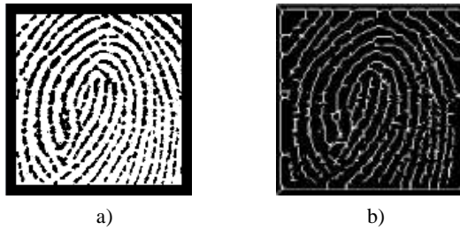
Fig.3. (a) Huella adquirida del sensor, (b) Huella esqueletizada
