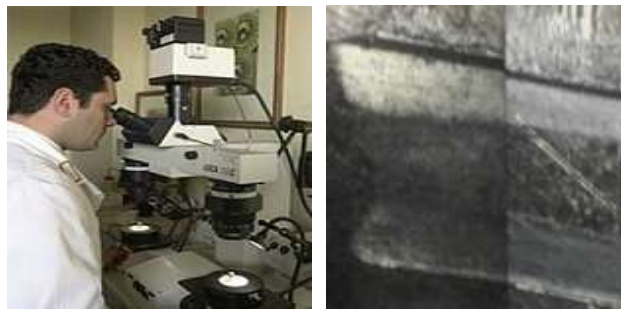
Figura 2. Cotejo balístico utilizando un microscopio criminológico de comparación. La imagen de la derecha muestra la superposición de las imágenes de dos proyectiles.
