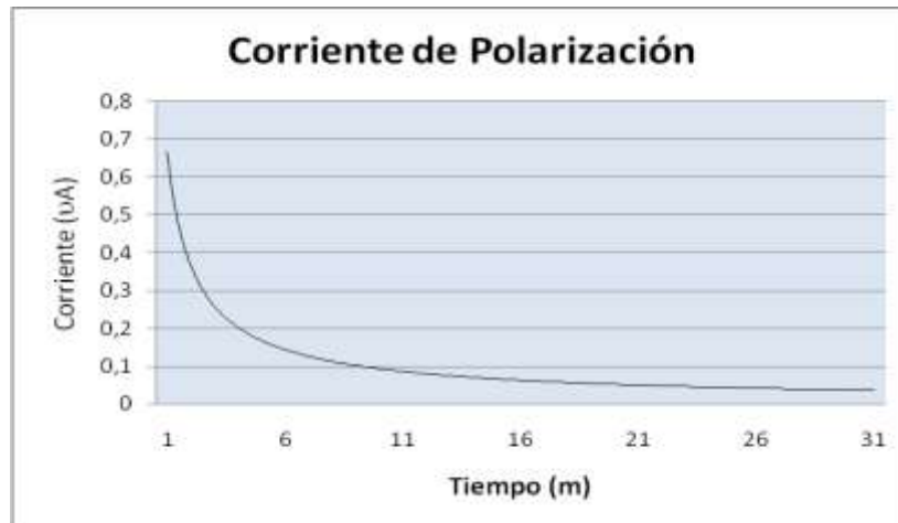
Figura 3. Curva típica de la corriente que atraviesa la muestra durante un proceso exitoso de polarización electro térmica.
