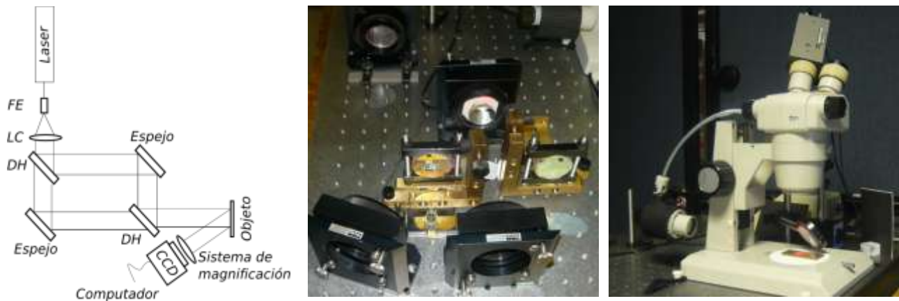
Figura 1. a) Esquema del montaje experimental para el registro de las imágenes de proyección de franjas. Aquí FE es un filtro espacial, LC una lente colimadora y DH es un divisor de haz. b) Detalle del montaje físico del interferómetro. c) El sistema de magnificación utilizado corresponde a la óptica de un estereo-microscopio en cuya base se proyectan las franjas. En el ocular se adapta el CCD.
