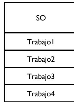
Figura 14. Cola de Trabajos en un SO multiprogramado
