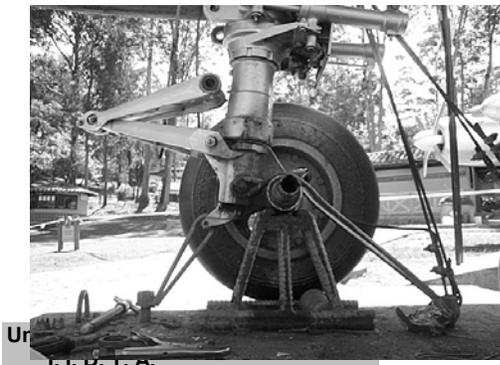
Fig. 7: Punto donde se pivota el avión.
