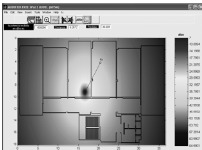
Fig. 8. Simulación de rango de cobertura MFSM ( f=100 MHz, P_T = -7 dBm)
