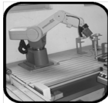
Fig. 3: Segunda Estación, Manipulador Mitsubishi
