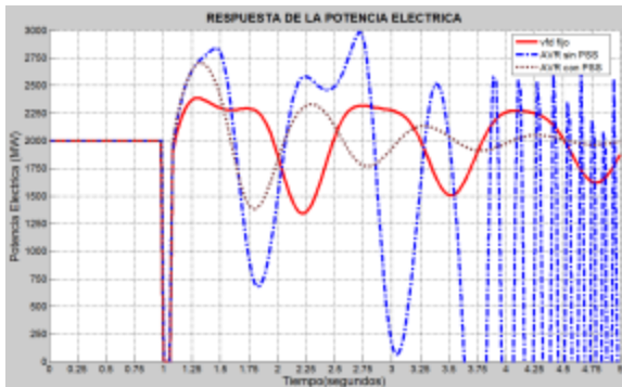
Fig. 11. Respuesta de la potencia activa del generador.
