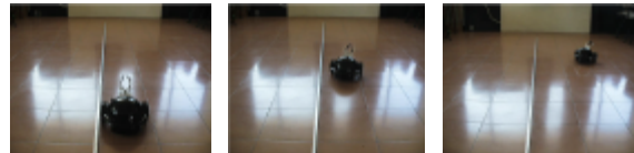
Fig. 15. Avance del robot sin controlador de orientación
