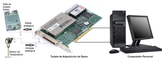
Fig. 2. Sistema de adquisición de datos.
