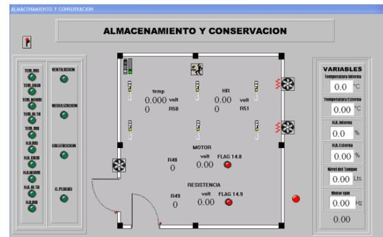
Fig.9. Panel Cámara de almacenamiento
