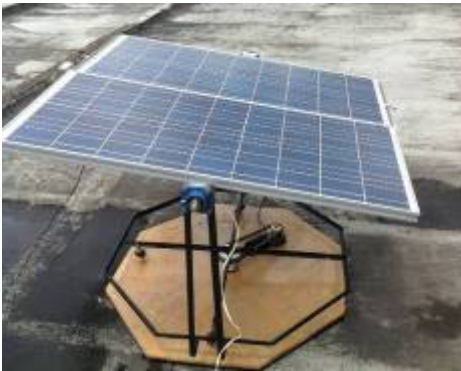
Fig.7. Generador energía solar tipo girasol instalado.
