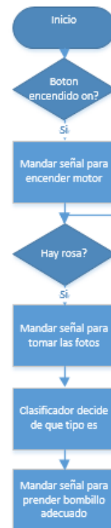
Fig. 4. Diagrama de flujo del prototipo.
