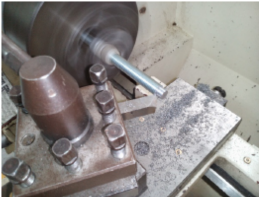
Fig. 11. Torneado de ejes para la máquina.
