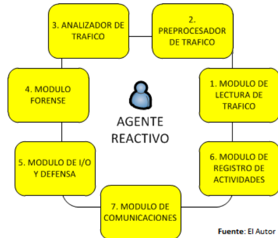
Fig. 2. Arquitectura de un agente reactivo.
