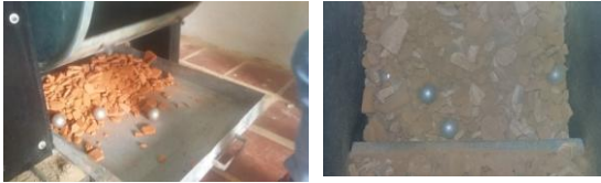
Figura 5. Muestra de estudio en la máquina de los Ángeles. Fuente: Elaboración Propia
