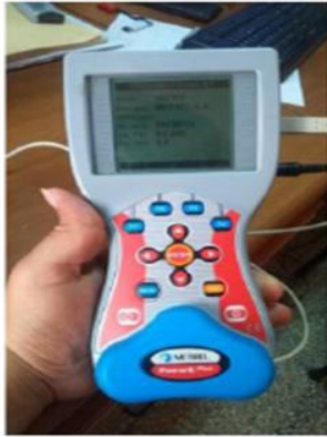
Figura 2: Analizador de red marca METREL.
