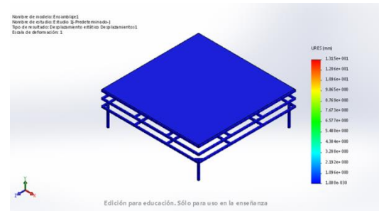
Figura 8. Análisis de desplazamiento de la mesa vibratoria
