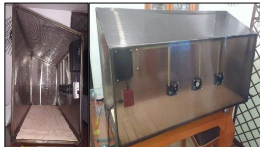
Fig. 1. Prototipo de invernadero automatizado a escala para el secado de granos de cacao
