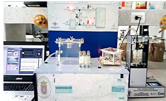
Fig. 4. Nariz electrónica B-NOSE acoplado al sistema de extracción de volátiles..
