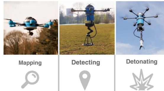
Fig. 7. Mine Kafon Dron para mapeo, detección y detonación de minas. Fuente: Hassani, 2016.
