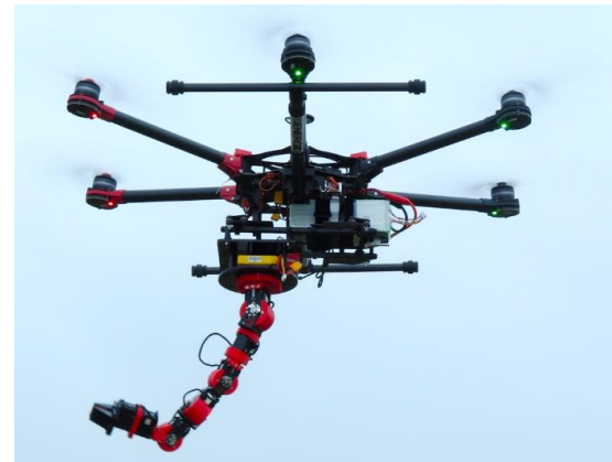
Fig. 8. Dron con brazo robótico de 7 grados de libertad de Energid. Fuente: Tardela, 2016.
