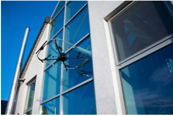
Fig. 6. Dron para limpieza de ventanas. Fuente: Fritzsche, 2016.
