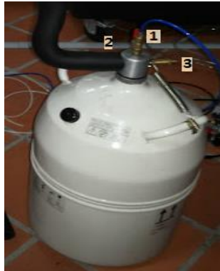
Figura 6. Tanque de almacenamiento de LN 2 y su respectivo tapon 1) Entrada de aire, 2) Salida gas nitrógeno, 3) Válvula de escape.
