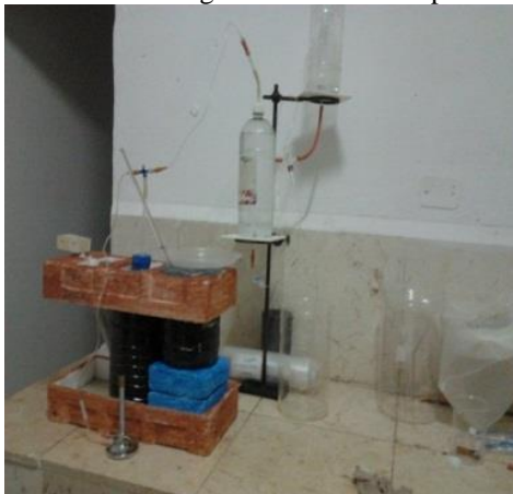
Fig. 1- Digestor anaerobio con gasómetro empleado en las mediciones.
