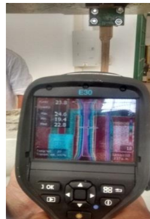
Fig. 3. Termografía aplicada a las probetas
