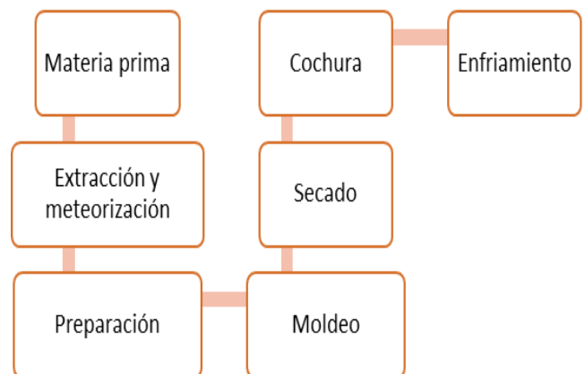
Figura 2. Esquema de la producción de ladrillo de arcilla.
