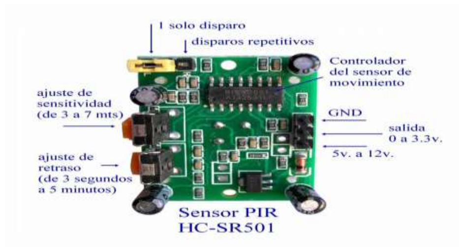
2 Vista de componentes del sensor PIR
