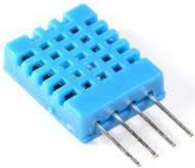
Ilustración 2 sensor de temperatura DHT 11.
