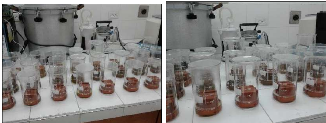
Figura 122. Aplicación ensayo de resistencia química
