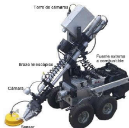
Fig. 4. Brazo telescópico con sensor de metales
