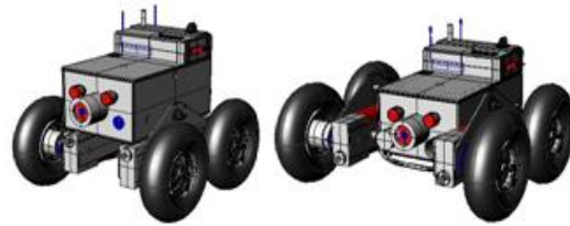
Fig. 3. Configuraciones del sistema de tracción diferencial
