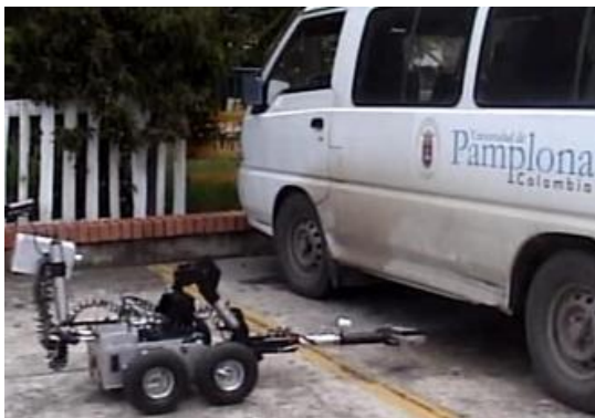
Fig. 5. Brazo Articulado inspeccionando vehículo
