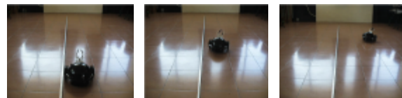
Fig. 15. Avance del robot sin controlador de orientación
