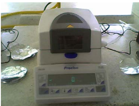
Figura 1. Balanza infrarroja empleada en las determinaciones de humedad de las muestras de aceite y grasa.
