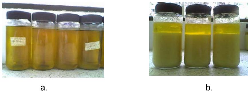
Figura 2. Estabilidad del aceite obtenido a partir del tratamiento térmico a. Aceite obtenido y b. Separación de fases luego de 24 horas.
