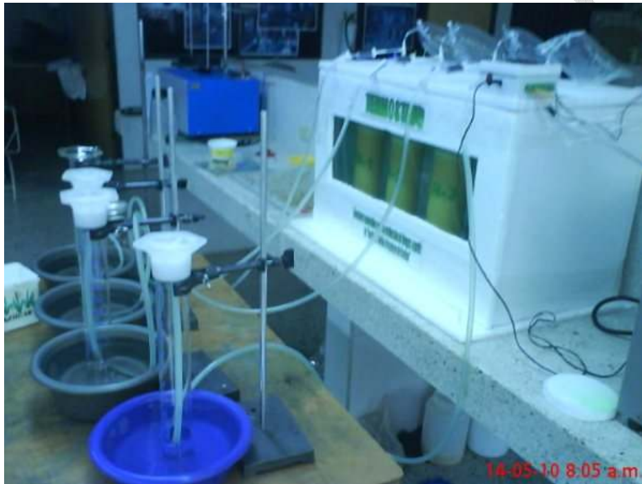
Figura 2. Montaje utilizado para la medición de producción de biogas
