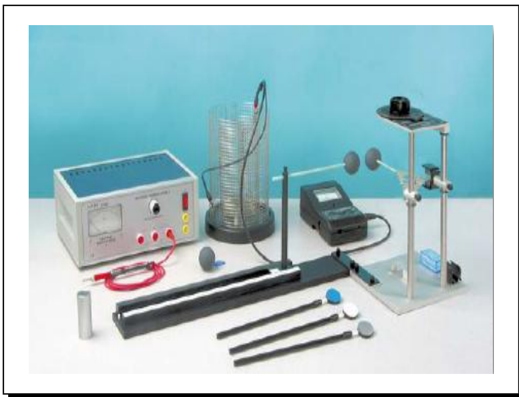
Figura 3.1: Montaje para la determinación de la constante de Coulomb
