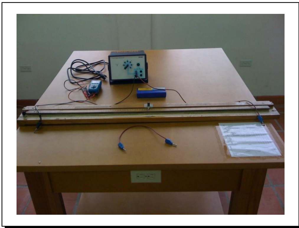
Figura 3.6: Montaje para determinar la resistividad del un material conductor
