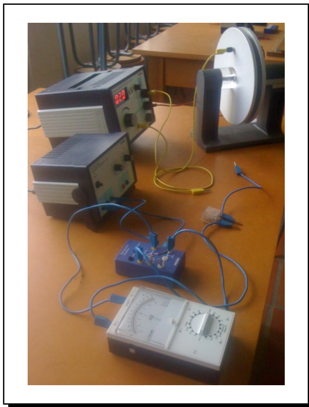
Figura 3.5: Montaje para calcular la permitividad del aire
