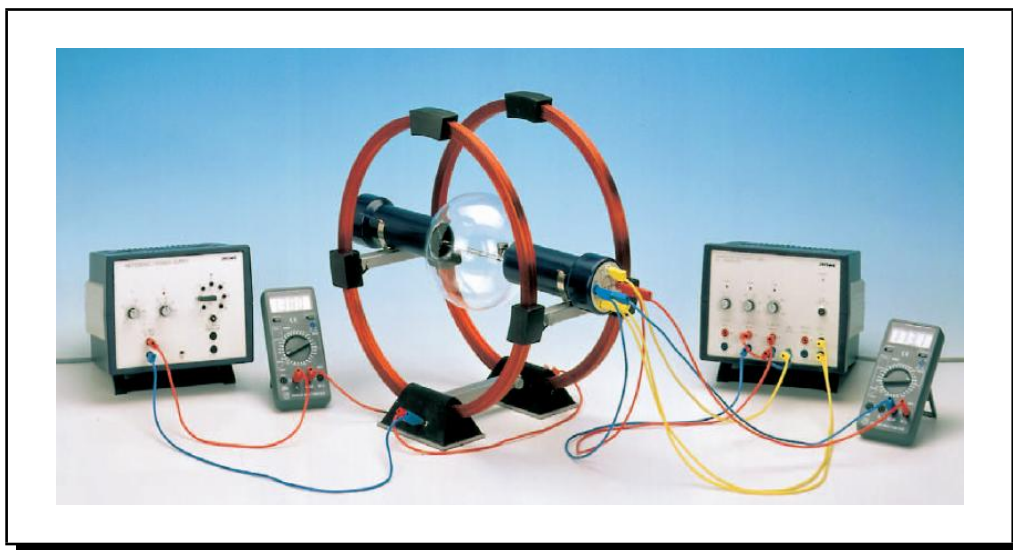
Figura 3.30: Montaje para la determinación de la relación carga masa
