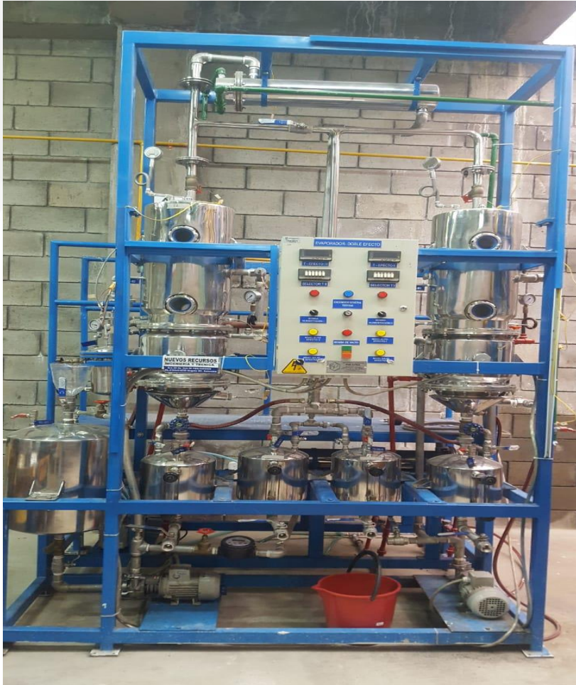
Planta piloto Evaporador de doble efecto.
