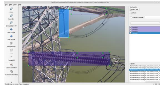
Fig. 5. Etiquetado de aisladores eléctricos en líneas de transmisión eléctrica usando el software Label-Img. Fuente: Autores
