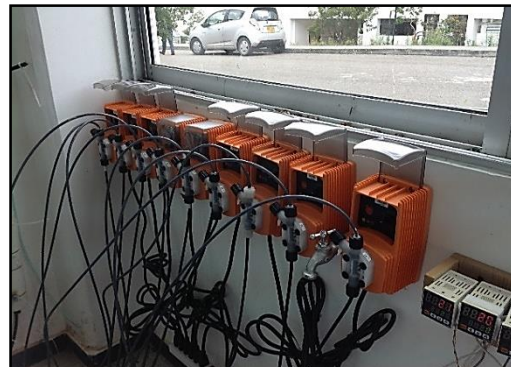
Foto 44: Equipos (bomba dosificadora de caudal 2i/h a 20bar (290 psi))
