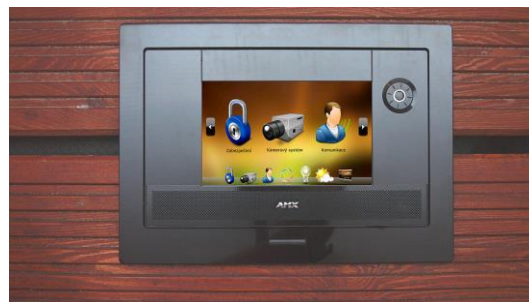
Fig. 2. Un panel de control doméstico, capaz de controlar la iluminación, termostato, seguridad, cerraduras y entretenimiento doméstico.
