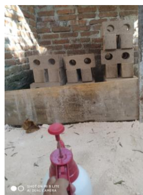
Fig. 3. Proceso de curado y acomodación del BTC.
