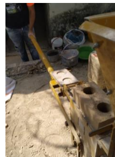
Fig. 2. Fabricación de BTC en la cimbarra.
