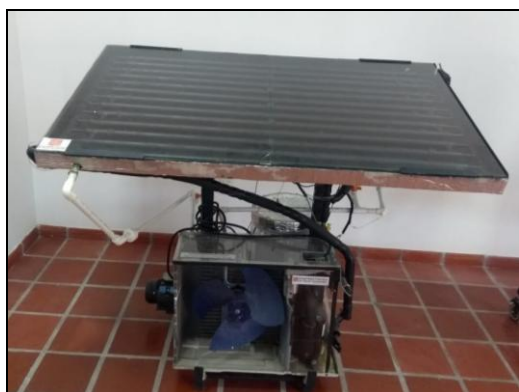
Fig. 1. Módulo prototipo calentador de agua
