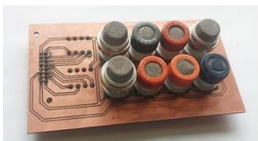
Fig. 7. Matriz de sensores MOS del dispositivo SOE-I
