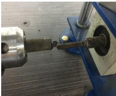
Figura 8. Fractura del espécimen sometido a ensayo fatiga
