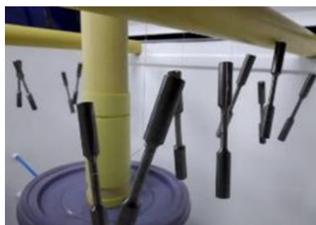
Figura 6. Especimen corroído en cabina de niebla salina durante 15, 30 y 45 días
