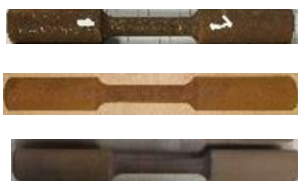
Figura 6. Especimen corroído en cabina de niebla salina durante 15, 30 y 45 días
