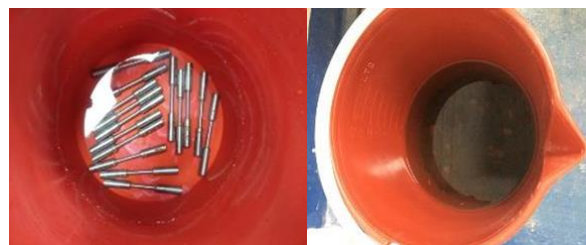
Figura 3. Corrosión de probetas por inmersión
