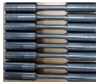
Figura 2. Probetas maquinadas para el ensayo
