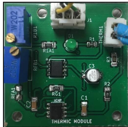
Fig. 4 Circuito de acondicionamiento ensamblado
