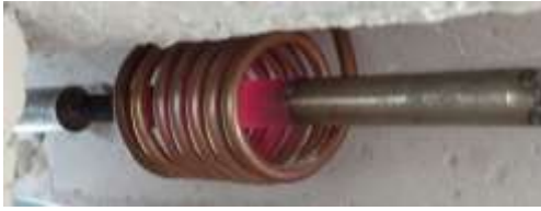
Figura 13. Ensayo de calentamiento por inducción
