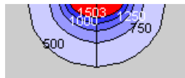
Fig. 6. Previsión de isothermas con SmartWeld con fuente de calor gaussiana en movimiento y en estado estacionario sobre platina semi-infinita
